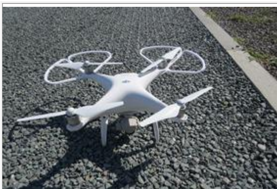
障害物回避センサーを備えているので、プロペラガードは後ろ側だけにあります。
