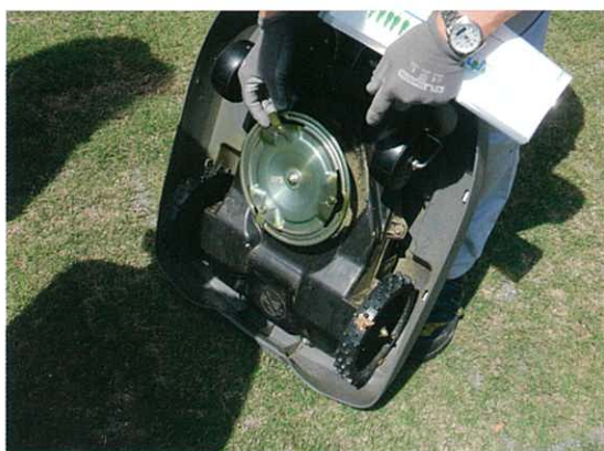
裏側のブレードの様子
