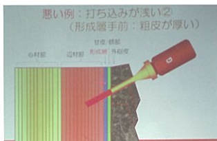
樹幹注入の悪い例
