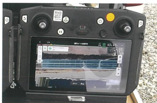
コントローラで設定ルート上の飛行位置を確認
